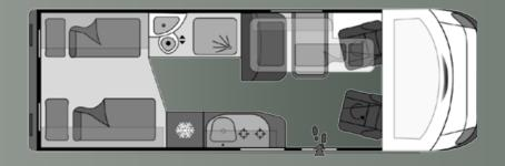
Réservoir eau propre 90 l Réservoir eau usée 100 l Emplacements gaz 2 x 11 kg Masse en service **3105 kg** PTAC **3500 kg** Nombre de places carte grise **4**
