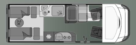
Réservoir eau propre 90 l Réservoir eau usée 100 l Emplacements gaz 2 x 11 kg Masse en service **3185 kg** PTAC **3500 kg** Nombre de places carte grise **4**
