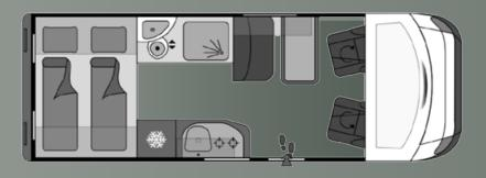
Réservoir eau propre 90 l Réservoir eau usée 100 l Emplacements gaz 2 x 11 kg Masse en service 2985 kg PTAC **3500 kg** Nombre de places carte grise 4
