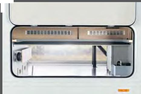
Double plancher protégeant les circuits d'eau du gel pour qu'ils résistent à l'hiver - hauteur utile de 360 mm et chargement transversal.
