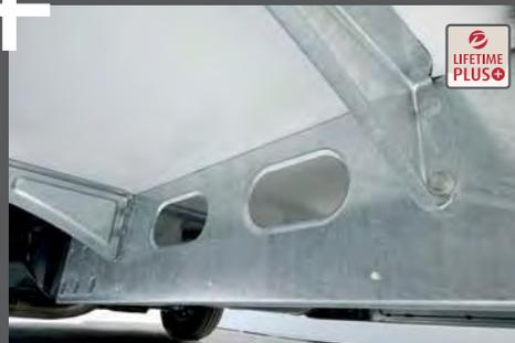
Dethleffs Lifetime Plus : le sous-plancher sans tasseaux bois est doté d'un revêtement polyester, de parois latérales à tasseaux en PU et d'une isolation XPS
