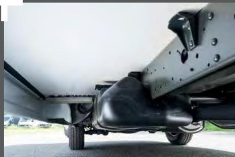
Technologie de construction durable Lifetime Plus sans tasseaux bois ! Sous-plancher à revêtement polyester.
