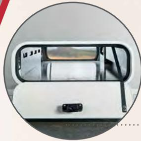
**Construction double plancher moderne** protégeant les installations du gel pour qu'elles résistent à l'hiver et offrant un espace de rangement supplémentaire (hauteur 260 mm)
