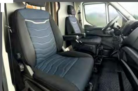
Sièges conducteur et passager ergonomiques, réglables à plusieurs niveaux, avec chauffage de siège et suspension hydraulique,
