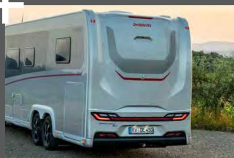
Arrière polyester au design automobile pour une isolation renforcée et une intégration esthétique de la caméra de recul et du troisième feu de freinage
