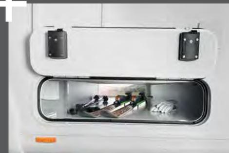
À l'abri du gel : double plancher chauffant offrant un vaste espace de rangement avec chargement transversal
